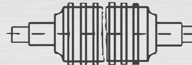
**Çizim 4** : Merdanenin Gövdeden Çapraz Kırılması
