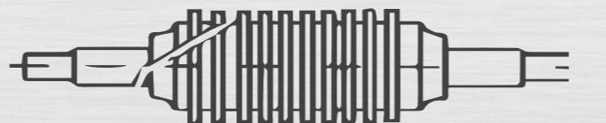
**Çizim 7** : Merdane Gövdenin Herhangi Bir Yerinden Bıçakla Kesilmiş Gibi Kırılması
