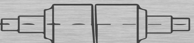
**Çizim 3** : Merdanenin Gövdenin Ortasından Bıçakla Kesilmiş Gibi Kırılması
